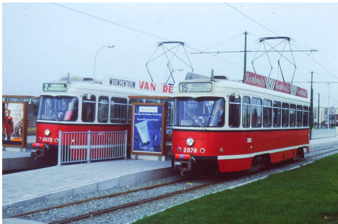
September 1990. Twee PCC's in een mooi rood jasje aan Terminus Linkeroever, kort na de opening van de Brabotunnel. De PCC's waren vroeger al met koppelingen aangepast om in duo te rijden.
