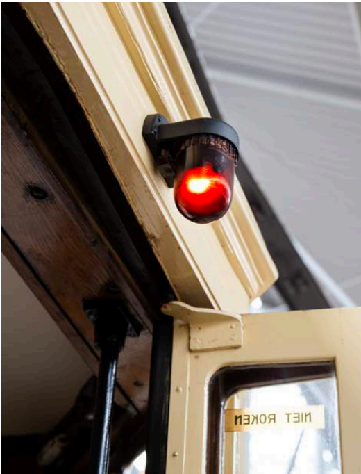
Een close-up van een 'apothekersfleske' - een richtingaanwijzer die niet pinkte.
