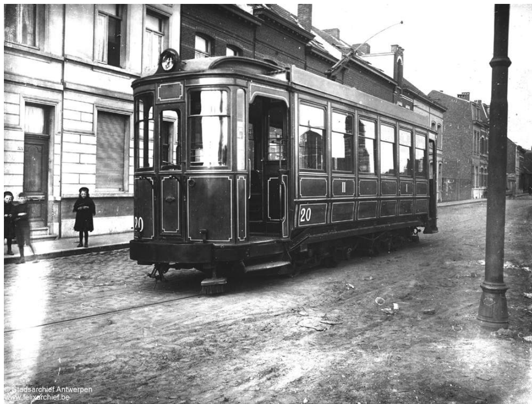
De fraaie motorwagen 20 van Les Vicinaux Anversois, de 'Rode Tram'. Let ook op de metalen borstel onderaan voor het reinigen van de sporen.
