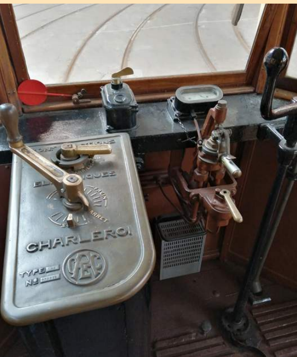
Een oude stuurpost met alle 'muziekinstrumenten' van de wattman. Van links naar rechts: de controller, de richtingaanwijzers, de remkraan met de manometers en de handrem.
