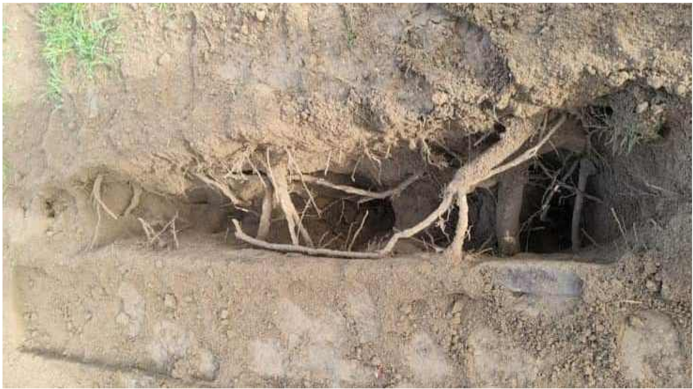
Foto proefsleuf wortelonderzoek
