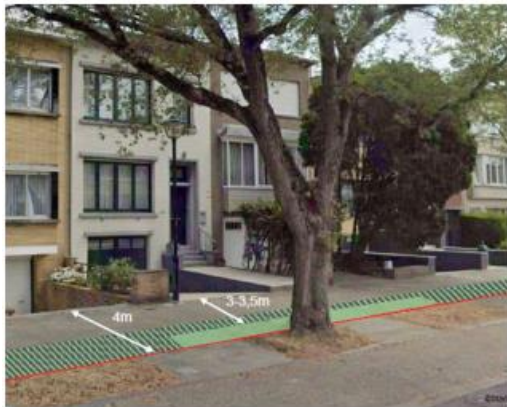
Impact door de nodige verharding voor de opstelruimte voor brandweer (minimaal 4m)
