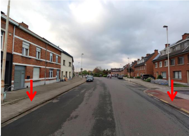
Rijweg met tweezijdig aanliggend fietspad
