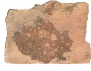
A234/24/T13. Een biscuit zonder engobe, met ovenverontreiniging.
