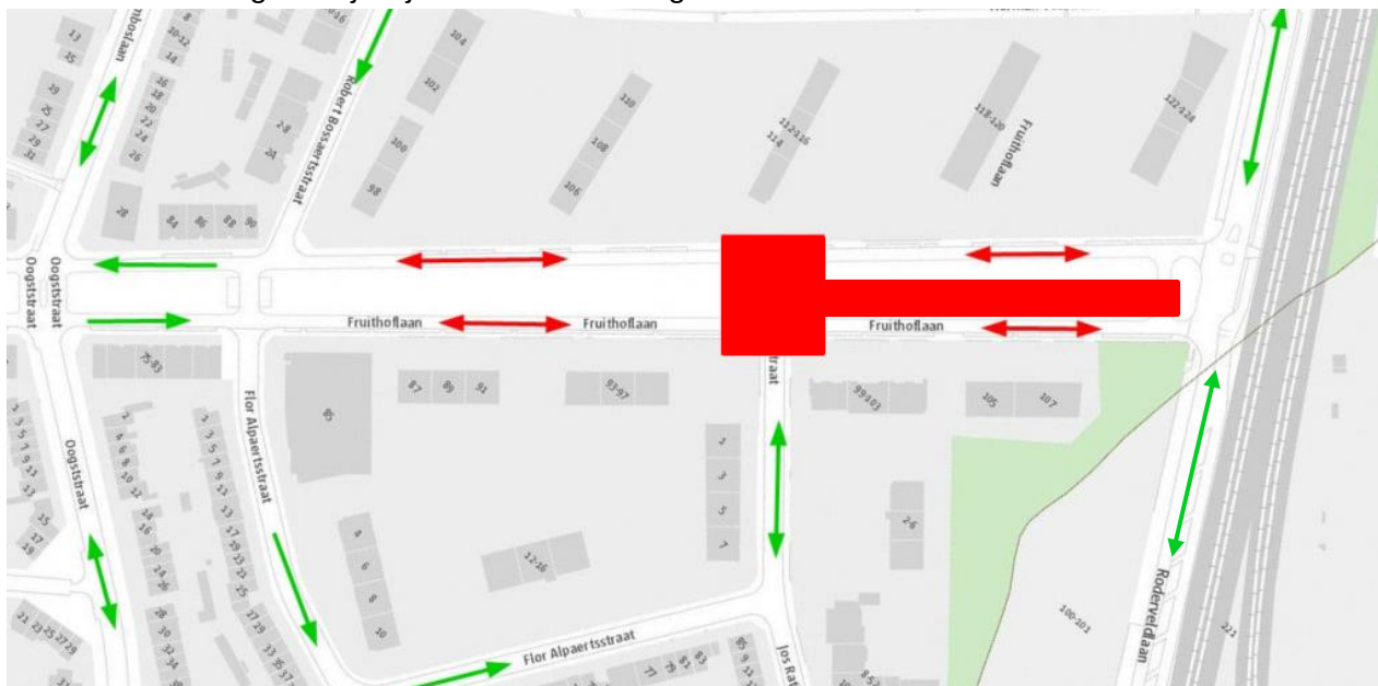
Tijdelijke situatie tijdens fase 2b: gedurende één tot twee weken is het kruispunt afgesloten.
