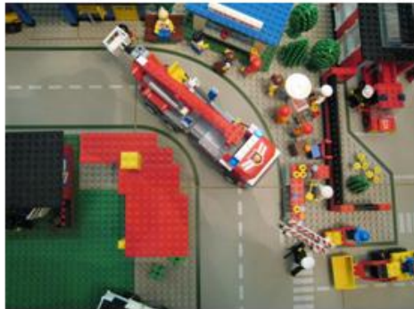
Door andere opstelling van het evenement (en door rekening te houden met de draaistralen) kan de brandweerwagen de bocht wel nemen.
